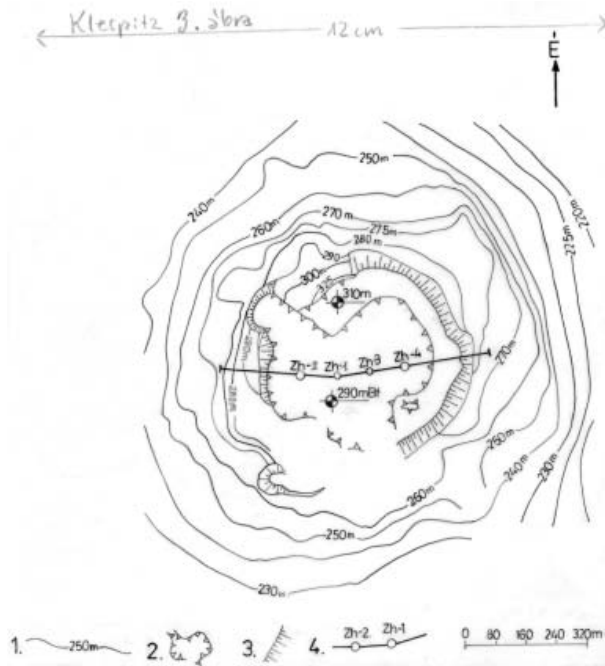
3. ábra. A Haláphegy és a bazaltbánya vázlatos térképe 1 - szintvonal (mB.f.), 2 - a bazaltbánya, 3 - meddőhányó, 4 - a földtani szelvény nyomvonala.
